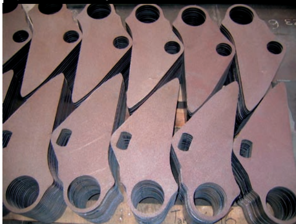
FIG|03 Alcune tipologie di componenti in lamiera realizzati dall'azienda. Emerge in particolare l'esigenza di un'efficace operazione di nesting.
