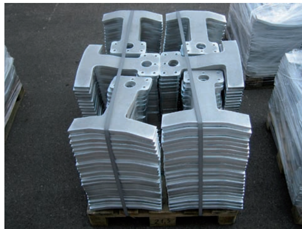
FIG06 L'impiego di materiale pregiato, come mostrano i pezzi in zincato della figura, esige in modo particolare un'elevata efficienza delle funzioni di nesting nel software in dotazione all'azienda.
